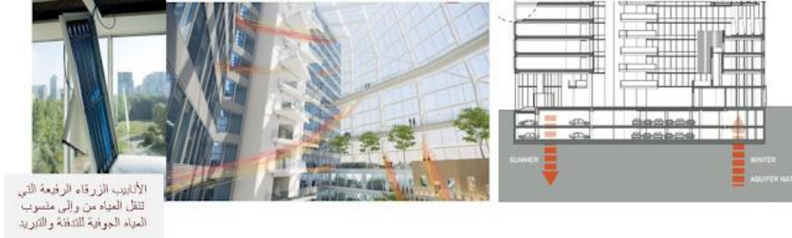
شكل ( ٥ ) التهوية الميكانيكية بنظام المبادل الحراري المزدوج التدفق بمبنى The Edge (١٨)
