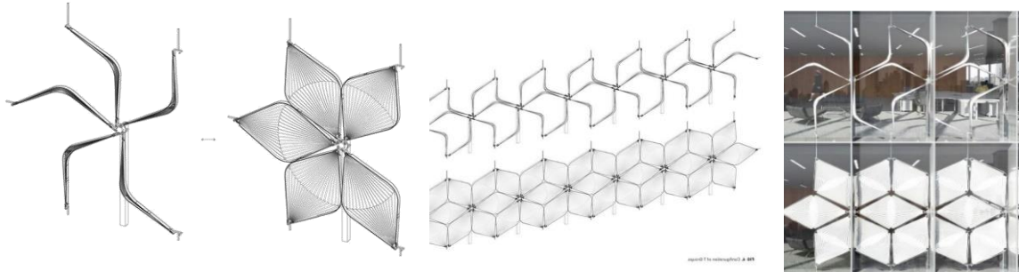
شكل (١٢) الفواصل الزجاجية معيارية وطرق تركيبها
