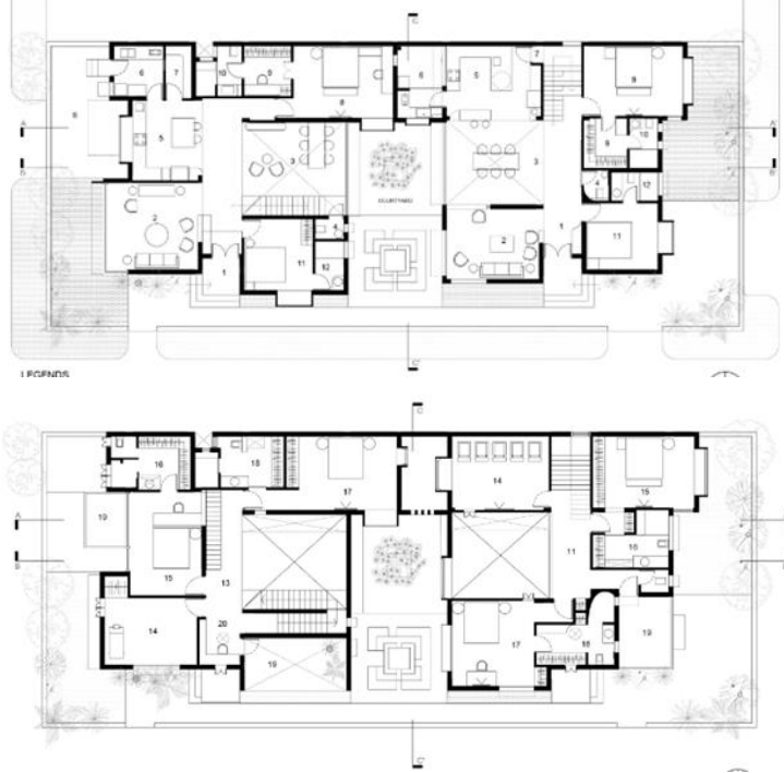
صورة (٤) مسقط أفقي للدورين الأرضي و الأول بوحدة سكنية يتضح بهما توزيع الفتحات المعمارية بالفراغات الداخلية المحيطة بالفناء الداخلي
