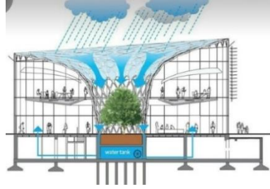
صورة (٦، ٧) توظيف السطح المائل الموجه نحو الفناء يزيد من كفاءة إدارة مياه الامطار والإشعاع الشمسي.
