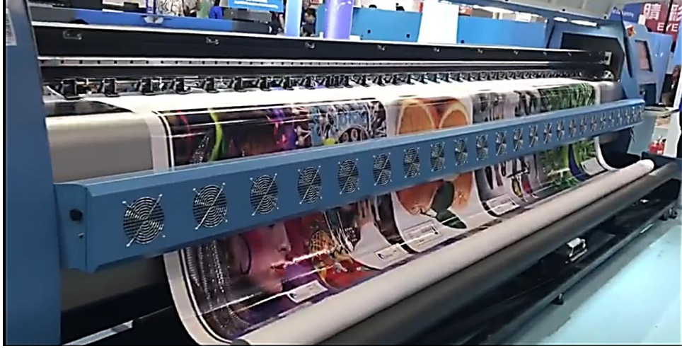
شكل (٧) طباعة رقمية بالنفت الحبري ذات الحجم الكبير (٥ متر) لطباعة خامات الإعلانات الخارجية (الفليكس والبانر) من طراز كونيك ٥١٢ أي
