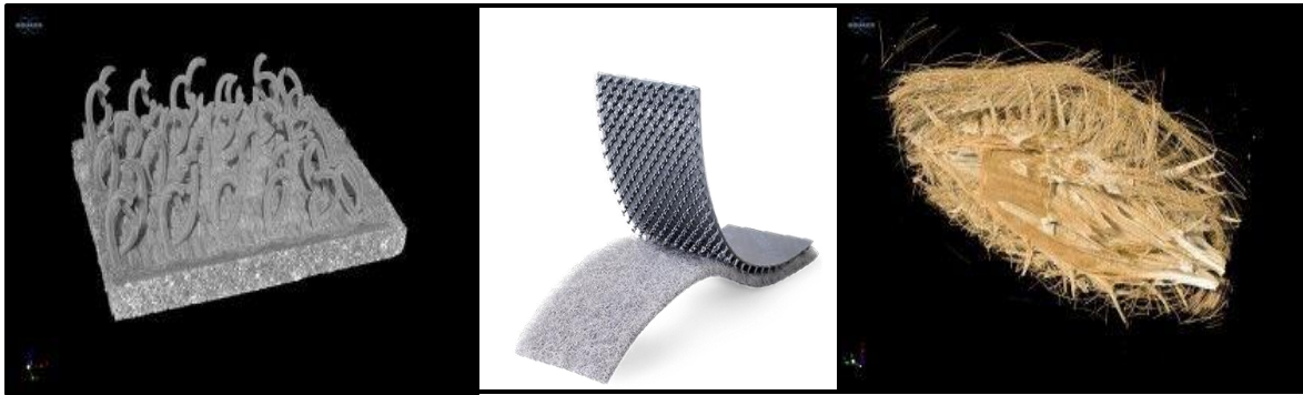
شكل (٥): يوضح شكل الفيلكرو والنبات المستوحى منه الفكرة "Burr" وشكل شعيرات الفيلكرو تحت الميكروسكوب
