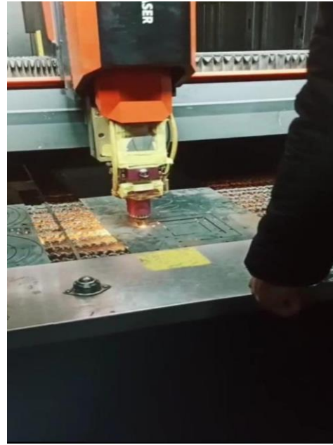
شكل (٦) حلقة التجميع الخاصة بالمعلقة وتقطيعها بماكينة الفايبير ليزر (الصور من تصوير الباحث)
