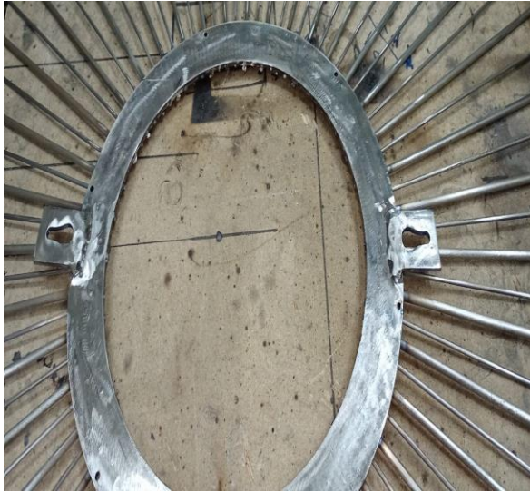
شكل (٦) حلقة التجميع الخاصة بالمعلقة وتقطيعها بماكينة الفايبير ليزر (الصور من تصوير الباحث)
