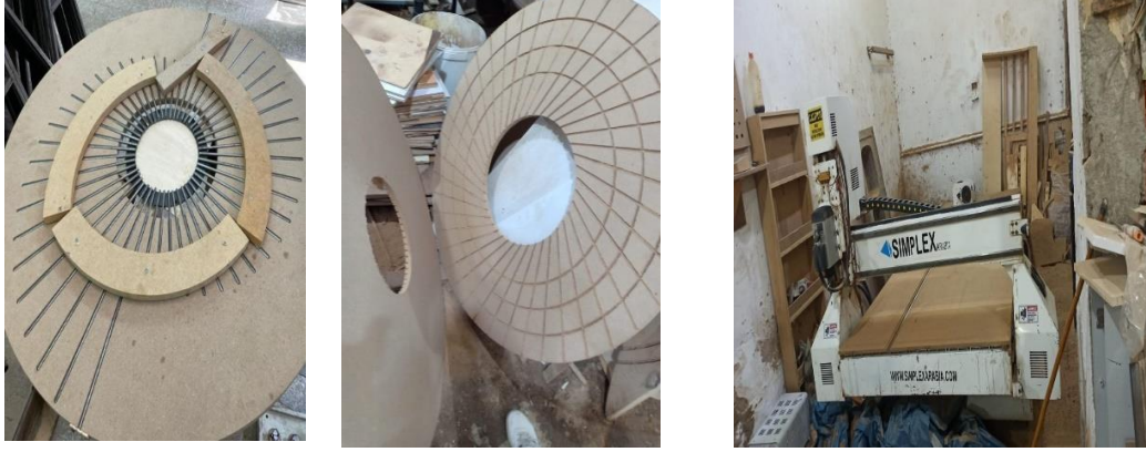
شكل (٧) يوضح شكل الراوتر وقالب التجميع الخشبي المستخدم صناعة المعلقات الفنية المعدنية التي تتميز بالخداع البصري. (من تصوير الباحث)
