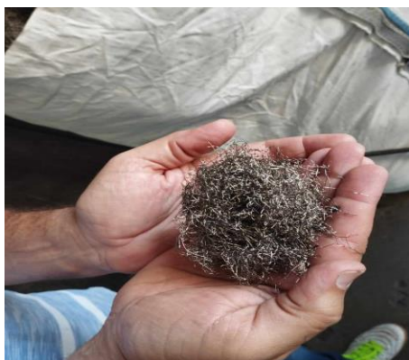
شكل (٩) جانب من الأجزاء المعدنية و بقايا سلك الإطارات و الذي تم فصله عن المطاط
