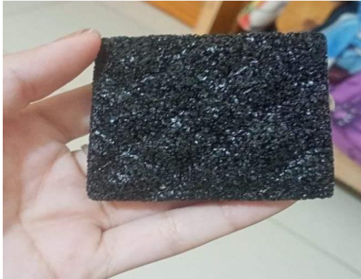
شكل (١١) عينة من البلاطات المصغرة المنفذة من حبيبات المطاط بإستخدام قوالب السيليكون
