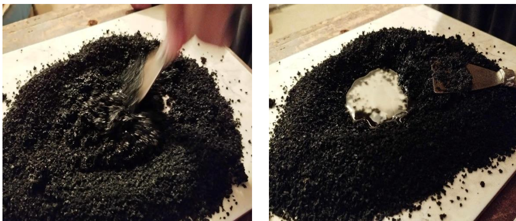
شكل (١٢) جانب من عمليات الخلط اليدوي لحبيبات المطاط مع مادة ال Polyurethane (PU) لإنتاج عينة البحث
