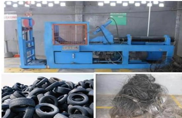
شكل (٥) عملية نزع الشنبر المعدني عن جانبي الإطارات المستهلكة
