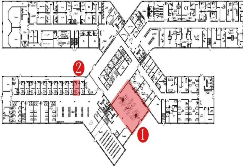
شكل 2 المسقط الأفقي للطابق الأرضي بالمستشفى، موضح عليه أماكن الفراغات رقم (١) فراغ الاستقبال - رقم (٢) غرفة الكشف (الطبيب)
