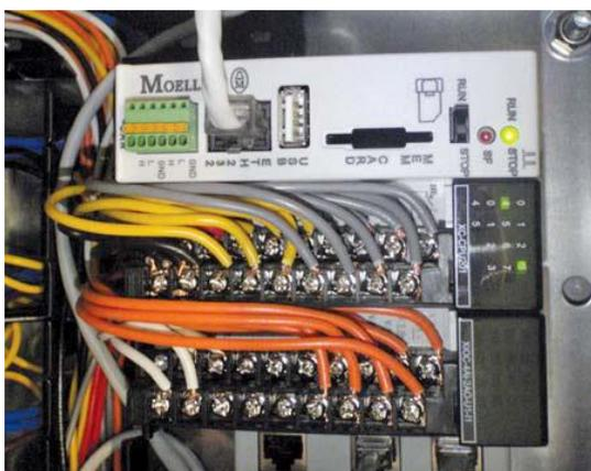
شكل (٢٢) نظام التحكم في ضغط الوسادة وهي تفصيلية بداخل نظام المضخة
