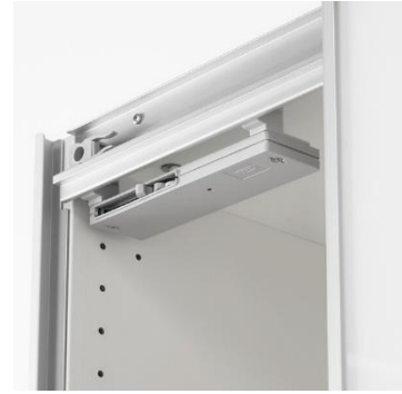
شكل ٩ أداة الإغلاق بسلاسة تخفف سرعة إنزلاق الأبواب لكي تغلق ببطء وهدوء ونعومة.
