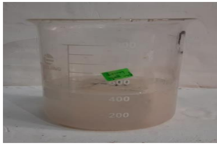
صوره (٦) توضح غمر عينة أخرى من إحدى عينات المونات في مواد التقوية
