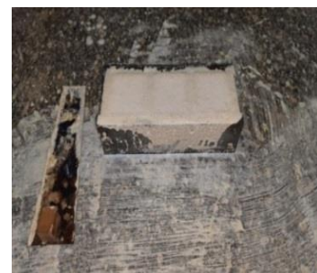
صوره (٢) توضح صب عينات من المونات التي يتم عليها الدراسات التجريبية
