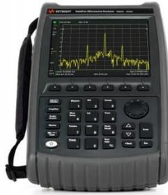
الشكل (٨) جهاز قياس الترددات الراديوية
