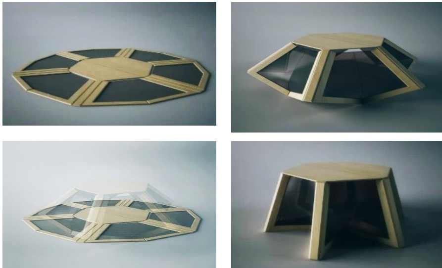
صورة رقم (١١) يطلق عليها اسم The Programmable Table، وهي قطعة أثاث مصنوعة باستخدام عملية Wood-Skin. يدمج الأسلوب نسيجاً مُجهَد مسبقاً في الهيكل الخشبي للسماح له بتحويل نفسه إلى أشكال يمكن التنبؤ بها. على عكس الأثاث القابل للطبي الموجود، فإن هذا النموذج الأولي الذي تم تصنيعه في مختبر التجميع الذاتي التابع لمعهد (ماساتشوستس للتكنولوجيا) Wood-Skin لا يعتمد على المفصلات أو الأجزاء المعقدة الأخرى لإعادة تشكيل نفسه. إذا كان الأثاث بحاجة إلى النقل، فيمكن تسويته مرة أخرى لتسهيل نقله.
