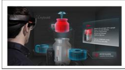
شكل (١٠) يوضح بدمج الواقع المعزز والمختلط لدليل صيانة لمضخة تفريغ
