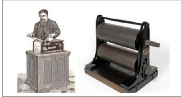
شكل (١) يوضح آلة طباعة تنقل الحبر الرطب من رسالة مكتوبة حديثاً إلى ورقة أخرى لانشاء نسخة منها
