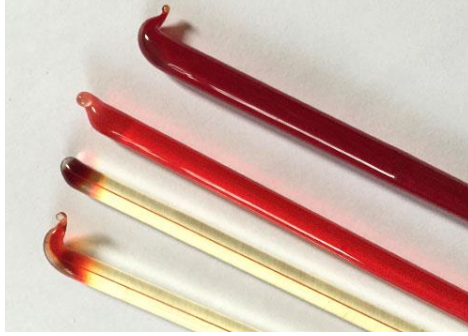
شكل (١١) تأثير أجزاء من عمود زجاج من الألوان التي تتغير بالحرارة بلهب المشعل
