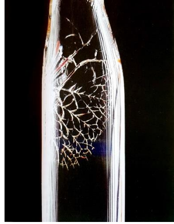
شكل (١٣) مظهر شبكة العنكبوت الذي تتخذه الشروخ
