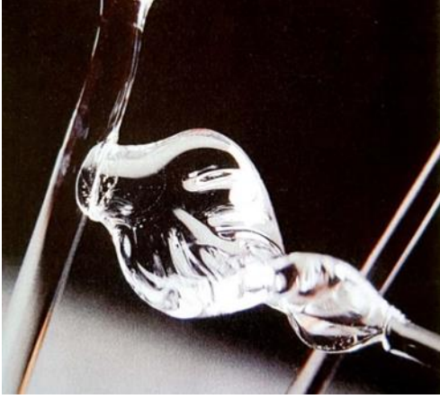
شكل (١٤) التجعد الناتج عن لصق قطعتين غير متساويتين في الحرارة
