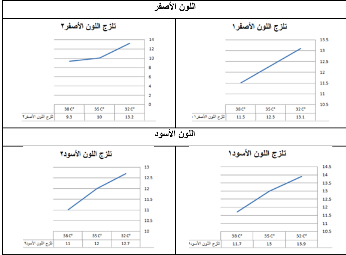
شكل رقم (٥): قيم التزلج للأحبار التشغيلية عند ارتفاع تأثير ارتفاع درجة الحرارة (٣٢٥ ، ٣٥٥ ، ٣٨٥).
