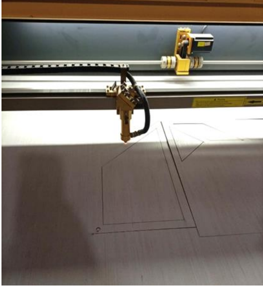
صورة رقم (٢٣) توضح توزيع أجزاء التصميم على اللوح الخشبي الرقائقي وعملية تقطيعه باستخدام ماكينة الليزر .
