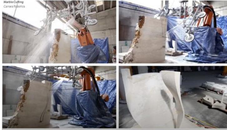
شكل رقم (٢٦) يوضح تنفيذ أحد التشكيلات بواسطة CNC مستخدما بلوك رخام كخامة تشكيل
