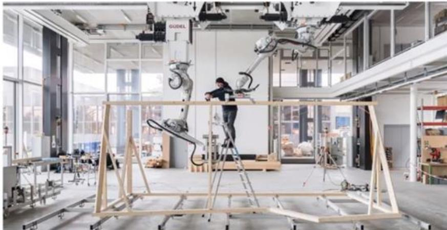
شكل رقم (٣١) يوضح استخدام العنصر البشري في تكامل مع ماكينات CNC لربط القطع بمسامير بعد اكتمال وضعها في مكانها بواسطة ماكينات CNC
