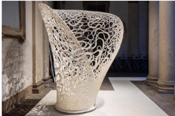
شكل رقم (٢٧) يوضح تنفيذ أحد الأشكال الديكورية بواسطة CNC مستخدما طباعة البلاستيك
