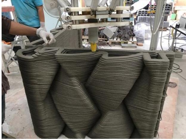
شكل رقم (٢٩) يوضح تنفيذ أحد التكوينات البنائية المعقدة بواسطة CNC مستخدماً طباعة الخرسانة
