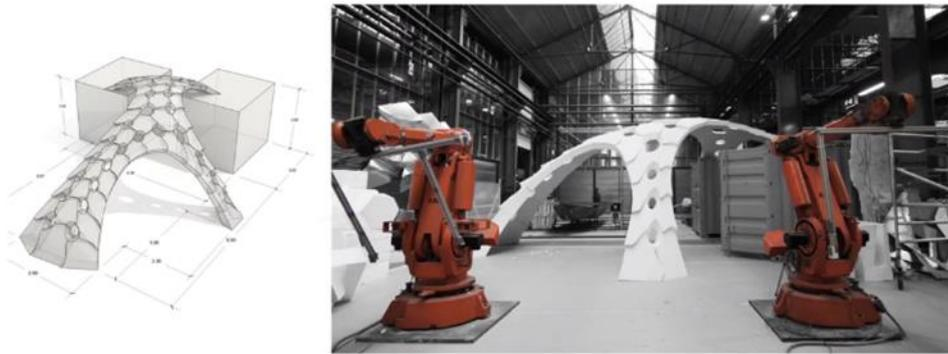
شكل رقم (٢٤) يوضح تنفيذ أحد التشكيلات باستخدام خامة الفوم
