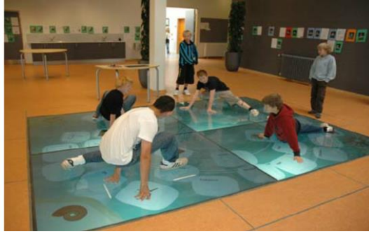
شكل (٥) الارضيات التفاعلية المكونة من بلاطات يتم تثبيت مجسات أسفلها للتفاعل مع حركة الإنسان.
