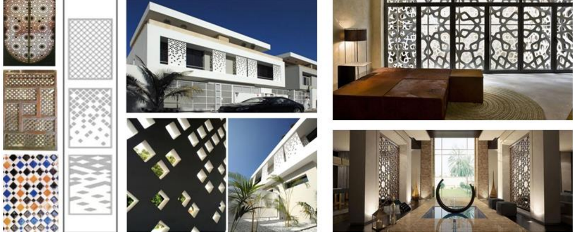
صورة (٢٠) تجريد الفكر التصميمي للمشرية الإسلامية من خلال عمليات التقسيم والحذف والإضافة و من ثم الحصول على تشكيل جديد يؤدي نفس الخصائص البنينة من راحة حرارية وخصوصية ونفاذ إضاءة طبيعية ولكن برؤية معاصرة
