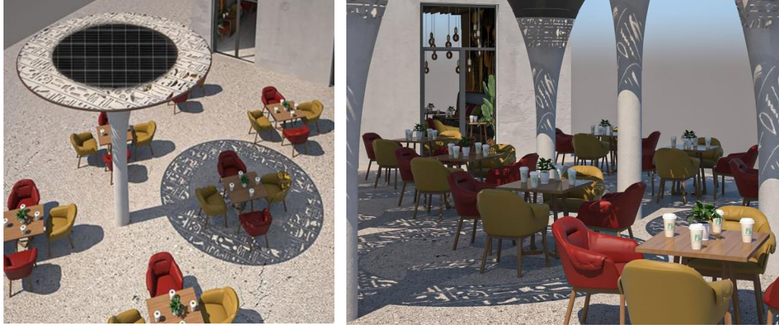
صورة (١٣) استخدام الخلايا الشمسية في تصميم أعمدة المظلات الخارجية بالمقهى لإنارتها ليلا وإنارة الساحة ككل، للاستفادة من شمس مدينة الأقصر، بهدف توفير الطاقة واستغلال الطاقة الشمسية النظيفة والمتجددة تطبيقاً لفكر التصميم المستدام وتحقيقاً لفكر التصميم البيئي الاقتصادي - تصميم الباحث
