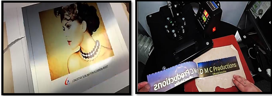
شكل (١١،١٠) يوضح نقل التصميم من الورق السبليميشن على الألومنيوم بواسطة المكبس الحراري
