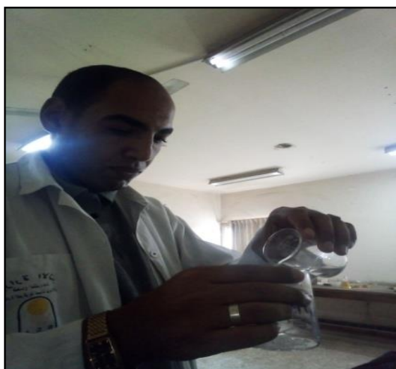
صورة (٣٧) توضح تحضير محلول ٧% من مادة فى Trimethylmethoxysilane ١٠٠ مللى من الكحول
