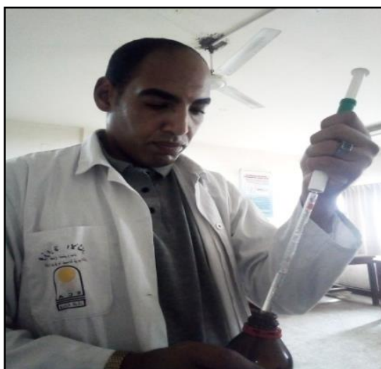
صورة (٣٦) توضح تحضير محلول ٧% من مادة Trimethylmethoxysilane
