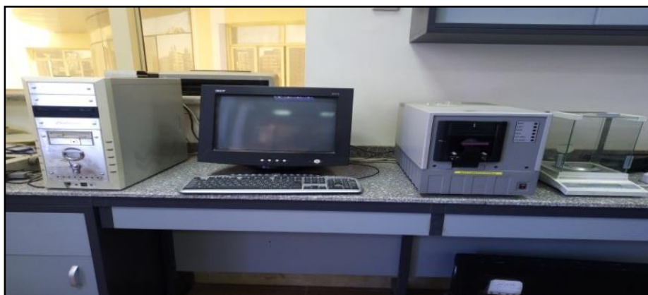
صورة (٢٩) توضح جهاز قياس التغير اللوني للعينات الحجرية
