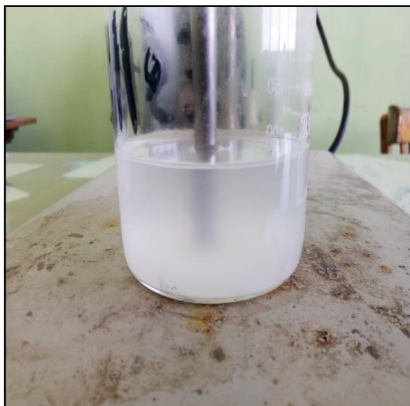
صورة (١٧) توضح طريقة الخلط باستخدام الاتراسونيك
