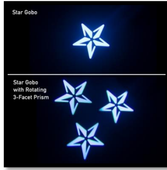
شكل (١١) يوضح دور المنشور الزجاجي الثلاثي 3-FACET PRISM
