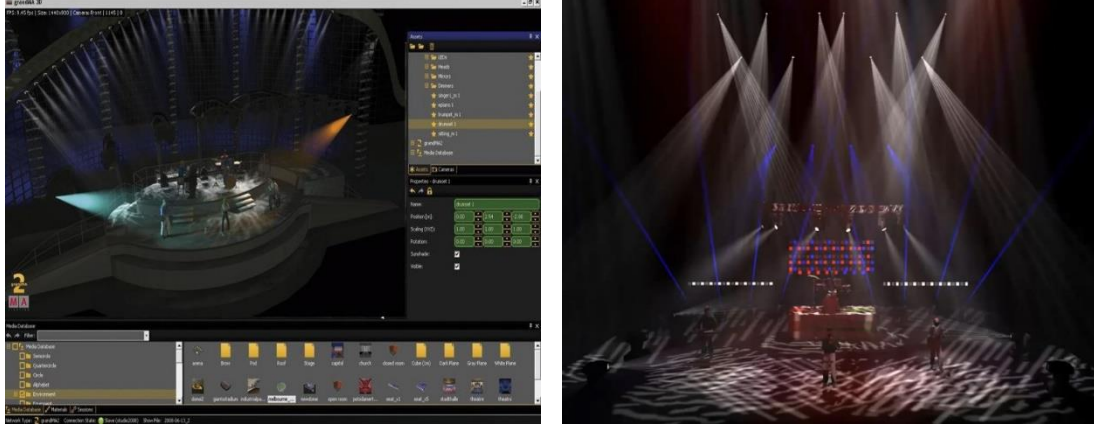
الشكل (٦) :- محاكاة GrandMA 3D. يمكن إدخال التصميم المعدة مسبقا من أي أداة نمذجة CAD أخرى.
